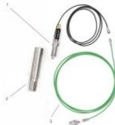
Pour les essais avec indication de pression dans le cylindre sur le moteur de test CT 150, la bougie normale est remplacée par une bougie instrumentée.
