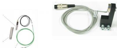
Pour les essais avec indication de pression dans le cylindre sur le moteur de test CT 150, la bougie normale est remplacée par une bougie instrumentée.
