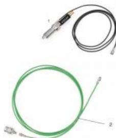
Pour les essais avec indication de pression dans le cylindre sur le moteur de test CT 100.20, la bougie normale est remplacée par une bougie instrumentée.
