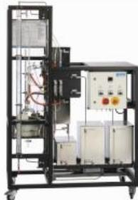
Le CE 620 permet de séparer les mélanges de liquides au moyen de l'extraction liquide-liquide.
