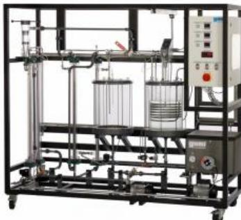
La cristallisation permet de transformer les matières dissoutes dans une solution en une matière solide et de les séparer.
