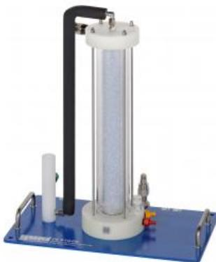
Les réacteurs à écoulement piston sont des réacteurs à écoulement tubulaire et fonctionnent en continu. Ils permettent l'étude de réactions chimiques dans des conditions définies. Le CE 310.05 fait partie d'une série d'appareils qui permet la réalisation d'essais sur différents types de réacteurs.
