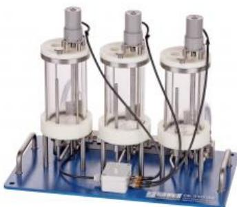
Les cascades de cuves agitées sont des réacteurs à cuves agitées montés en série.
