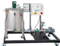
Le CE 285 alimente les bancs dessai de filtration en suspension de diatomite et deau (recommandée). Elle est préparée dans le réservoir de mélange.
