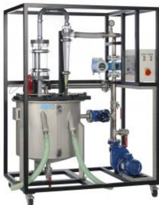
Les hydrocyclones permettent de séparer les matières solides en suspension dans un liquide. Dans le cas du CE 225, la suspension est préparée dans un réservoir.
