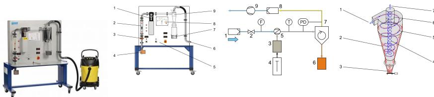
La séparation préliminaire des matières solides dans les gaz constitue une application des cyclones gaz. Cyclones gaz ne possèdent aucune pièce en mouvement et ne nécessitent par conséquent que très peu de entretien.
