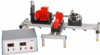
AT 200 est un dispositif d'essai complet composé d'une unité d'entraînement et d'une unité de freinage ainsi que de deux engrenages différents.
